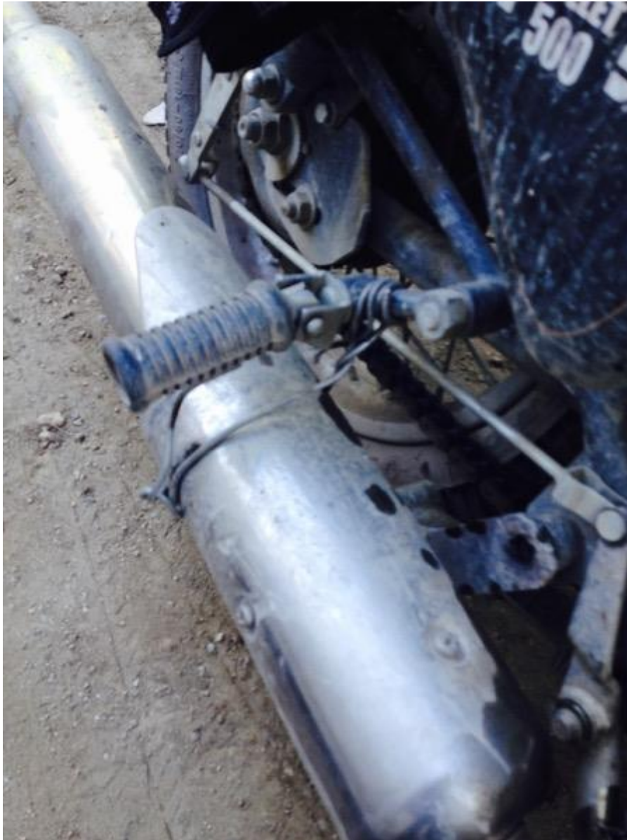
Abbildung 30 - Wackelige und verlorene Auspuffrohre. Ein häufiger Defekt mit immer gleicher provisorischer Reparatur mit Draht
